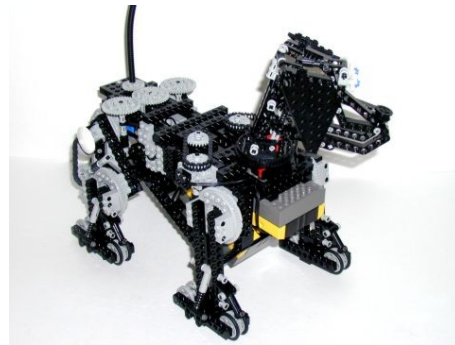
Σχήμα 9: Ρομπότ κατασκευασμένο με το σύστημα LEGO Mindstorms
